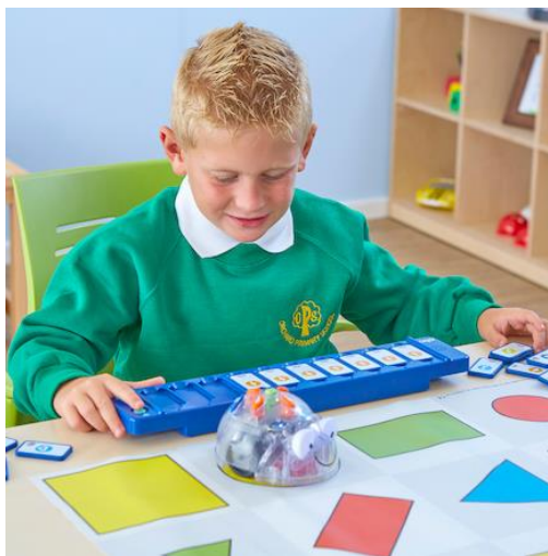
Obr. - Pro podobného robota Blue-bot existuje deska TacTile, na které lze program pro včelku skládat umísťováním kartiček na desku. Žák tedy celý program vidí a při chybě jej může snáze opravit.
