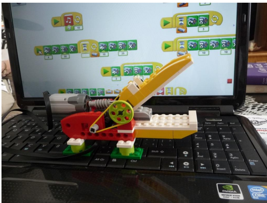
Obr. - Krokodýl postavený ve stavebnici v LEGO WeDo. Na pozadí jsou na monitoru programy, sestavené z ikon, které robota ovládají. Krokodýl má v „tlamě“ senzor vzdálenosti, který rozpozná, je-li do tlamy vložen předmět. V takové chvíli program spustí motor, který zavře krokodýlovi tlamu. Robot tak funguje automaticky, je naprogramován k jednoduché činnosti.
