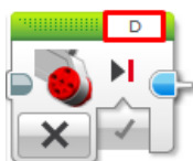
Obrázek 3.13 - Programovací blok Large Motor – volba výstupního portu
