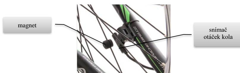
Obrázek 2.19 – Příklad instalace snímače otáček kola Apache ( https://ekolo.cz/Felektrosada-se-stredovym-motorem-ts250 )
