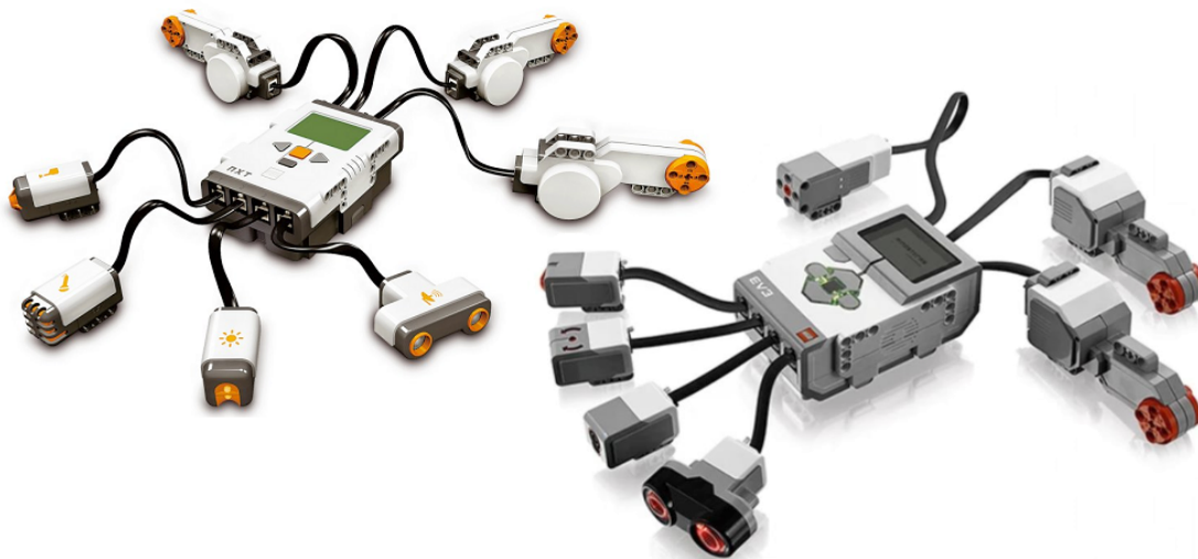
Obrázek 50: Řídicí jednotka s motory a senzory (vlevo starší verze LEGO Mindstorms NXT, vpravo nové EV3)
