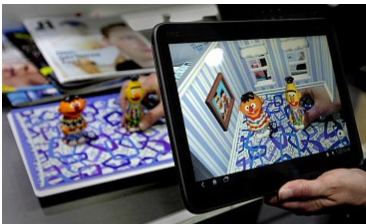
Obrázek 5.3: Ukázka rozšířené reality neboť jsou přidány stěny do reálné scény s použitím tabletu (převzato z [39]).
