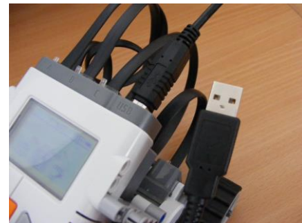
Obr. 33 Pripojenie riadiacej jednotky k počítaču
