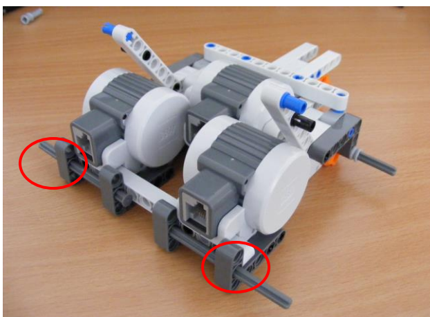
Obr. 5 Montáž zadných kolies
