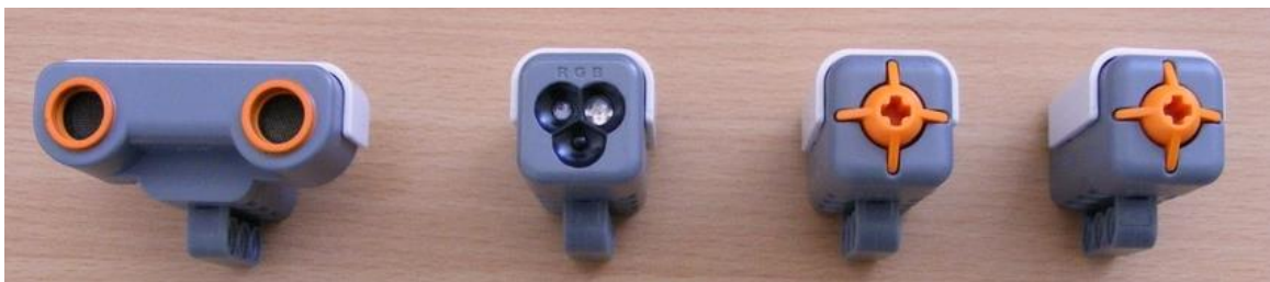
Obr. 15 Základná zostava senzorov: 1 ultrazvukový snímač, 1 snímač farby a svetla a 2 snímače tlaku
