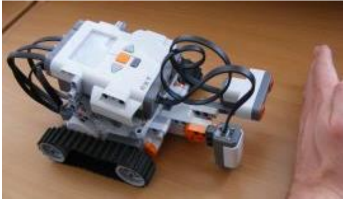
Obr. 29 Riadený robot - zastavenie robota pred prekážkou
